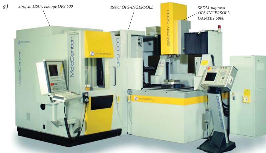
Slika 1: Obdelovalni centri z SEDM-napravo in strojem za HSC-rezkanje z avtomatizirano menjavo obdelovancev in elektrod
