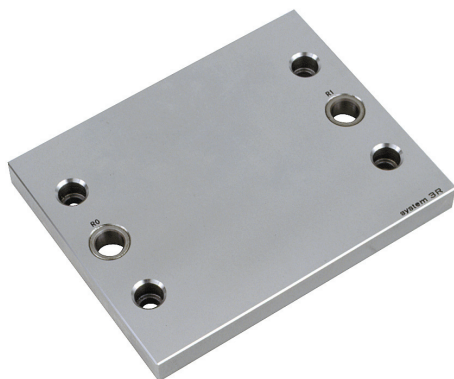
Slika 2: Paleta z izvrtinami za 3Refix čepe \Phi 20 mm in pritrditev z vijaki M10.
