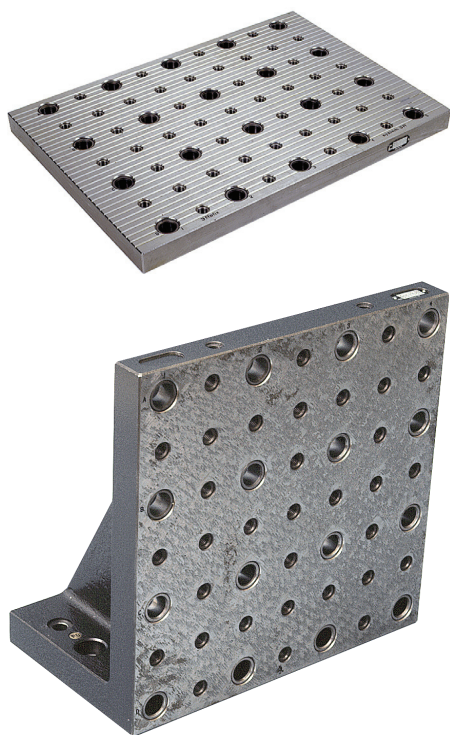
Slika 1: Horizontalna in vertikalna baza z izvrtinami za 3Refix čepe \Phi 20 mm in pritrditev z vijaki M10.
