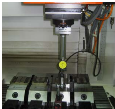
Slika 8: Kontrola baze na stroju za obdelavo s potopno elektroerozijsko obdelavo
