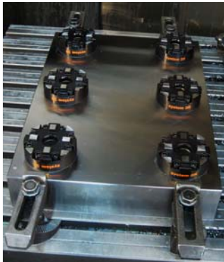
Slika 3: Plošča s šestimi bazami Macro Standard za izdelavo elektrod
