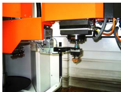
Slika 11: Potopna elektroerozijska obdelava
