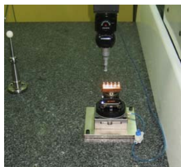
Slika 10: Kontrola elektrode na merilnem stroju
