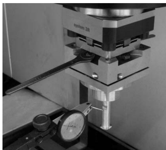
Slika 5: Izravnalna glava na stroju za potopno elektroerozijsko obdelavo.
