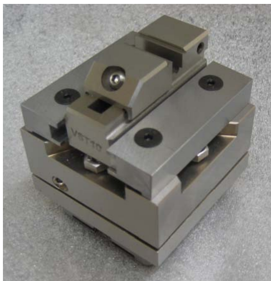
Slika 6: Izvedba izravnalne glave s primežem.
